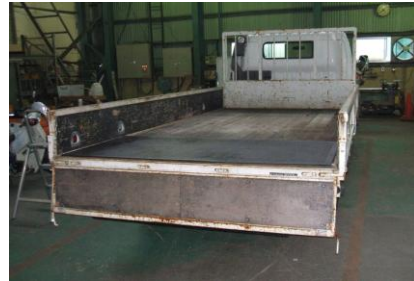
アピトン床板補強
